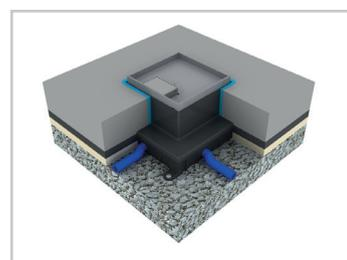
**7.** Mit den Nivellierschrauben die Kanten der Bodendose auf die Höhe des Fertigbodens nivellieren.
