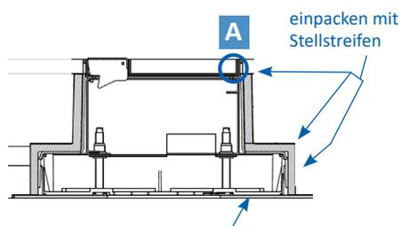
Einbaubox aufliegend auf 3mm Trittschall PE-H100 PL. 3 MM A/PE-Schaum, RG ca. 100 kg/m<sup>3</sup> anthrazit
