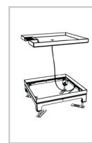
**Mis à la terre:** Les boîtes de sol doivent être installées et montées dans les règles de l'art. Tous les éléments métalliques conducteurs doivent être reliés entre eux et être cheminés vers un point. Un fil de masse est déjà préinstallé sur le dessous de la boîte de sol.
