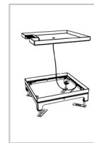
**Erdung:** Die Bodendosen müssen fachgerecht installiert und montiert werden. Alle metallisch leitenden Teile müssen miteinander verbunden und an einem Punkt zusammengeführt werden. Ein Erddraht ist beim Unterteil der Bodendose bereits
