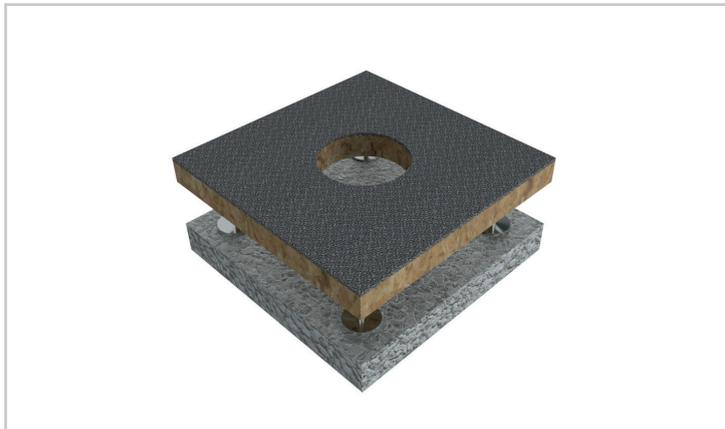
1. Im Hohl- oder Doppelboden ein Loch mit z. B. einem Hohlfräser 127 mm  $\varnothing$  auffräsen.
