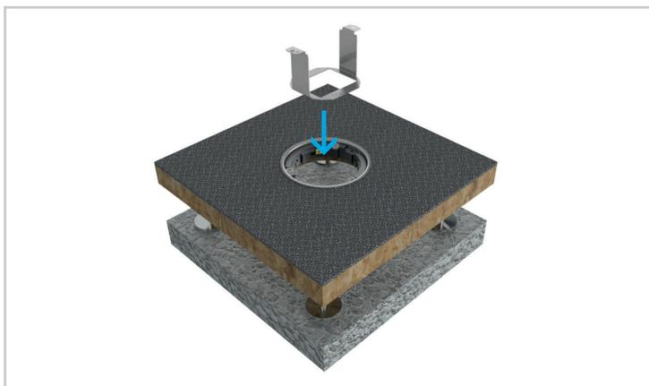
5. Ist ein Steckdoseneinsatz vorgesehen, muss dieser bei den vorgesehenen Befestigungspunkten angeschraubt werden.
