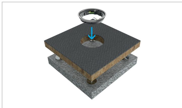
2. Insérez la partie inférieure du cadre dans l'ouverture découpée.
