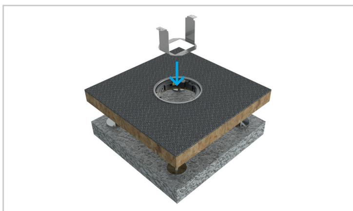
5. Si une prise de courant est prévue, elle doit être vissée aux points de fixation prévus.
