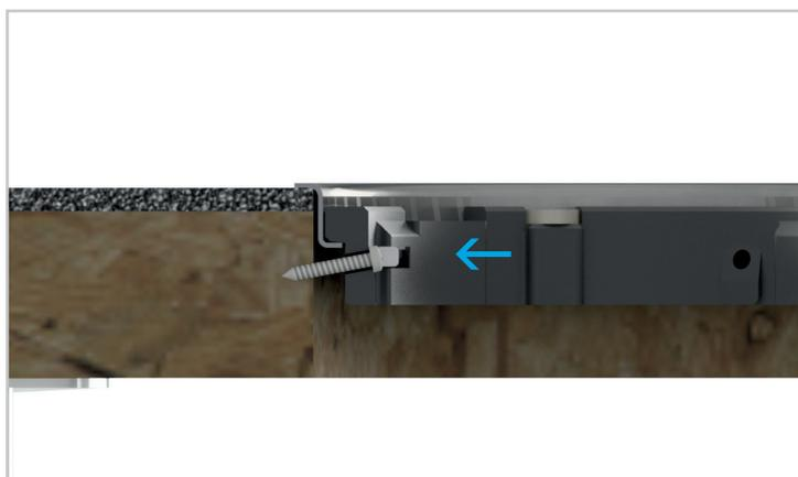
3. Fixer le cadre sur le côté avec les vis à bois fournies. Assurez-vous que les vis ne sont pas trop serrées, sinon le cadre risque de se déformer et le couvercle ne reposerait pas correctement.
