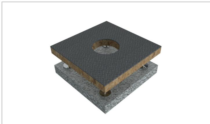
1. Fraisez une découpe dans le sol creux ou faux-plancher avec  $\varnothing$  127 mm (p.ex. avec une fraise creuse).
