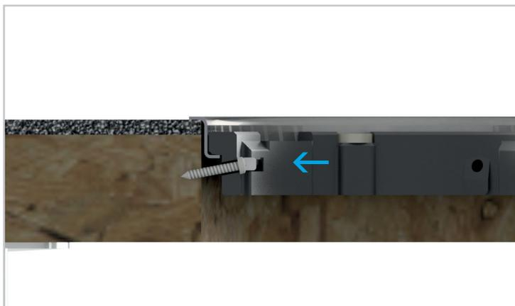
3. Mit den mitgelieferten Holzschrauben den Rahmen seitlich fixieren. Darauf achten, dass die Schrauben nicht zu fest eingedreht werden, sonst kann sich der Rahmen verziehen und der Deckel würde nicht richtig aufliegen.
