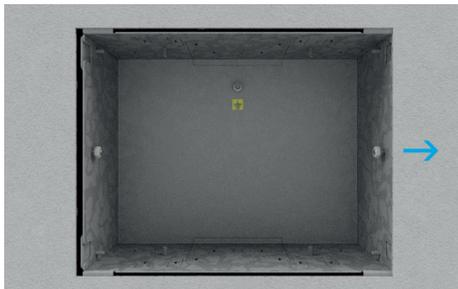
**1.** Auf beiden Seiten vom Gehäuse sollte die Oberfläche von jeglichem Schmutz befreit sein, v.a. bei den Muttern.
