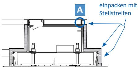
Einbaubox aufliegend WW auf 3mm Trittschall PE-H100 PL. 3 MM A/PE-Schaum, RG ca. 100 kg/m<sup>3</sup> anthrazit
